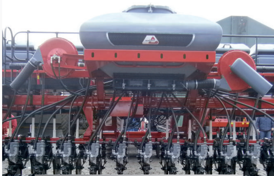
RESERVATÓRIO DE SEMENTE FASTFILL® 2.000 litros ~ 1.500 kg
