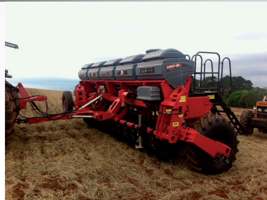
RESERVATÓRIO DE FERTILIZANTE - HC até 3.450 litros ~ 3.900 kg
