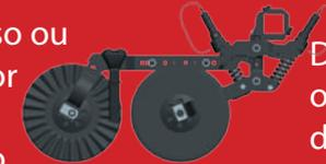
Disco de corte 20" liso ou ondulado fixado no suporte da linha da semente.
