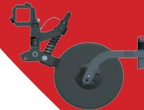
Disco de corte 20" liso ou ondulado + condutor que deposita adubo na superfície do solo
