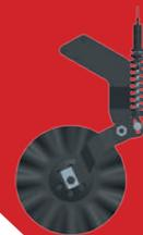
Disco de corte de 20", fixado no suporte da linha da semente podendo ser liso ou ondulado.
