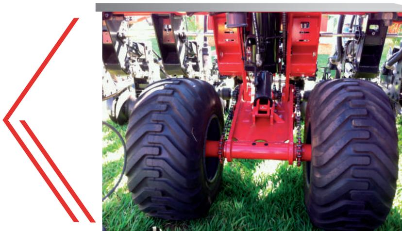
Os cilindros responsáveis pelo levante da máquina estão dispostos um em cada rodado e possuem um sistema de fixação com duas rótulas: inferior e superior.
