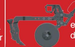
Haste com 10 mm de espessura + disco de corte de 20".
